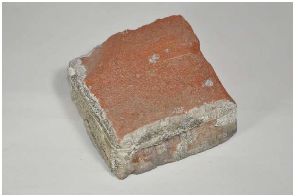
写真 5.3.16 刻印煉瓦(カマド周辺の敷煉瓦に使用)
