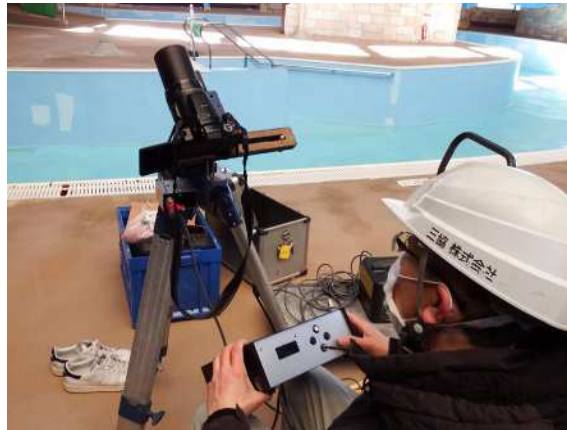
写真-9 撮影に使用した自動雲台搭載 2,000mm 望遠カメラ
