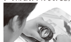
▲原図をもとに、ビュランという特殊な彫刻刀を使って金属板に点や線を一本一本刻み込み、原版を作製している様子 出典：国立印刷局ホームページ ( https://www.npb.go.jp/ja/intro/seizou_photo.html )
