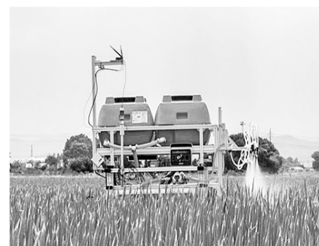
▲実証実験のためネギ畑で農作業中の『自律走行農薬散布ロボット』
