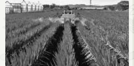
▲(株)レグミンの開発した自律走行型自動農薬散布機
