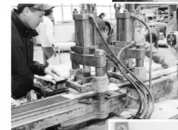
▲切断した木材を専用の機械でかんながけしている様子
