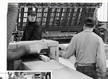
▲切断した木材を専用の機械でかんながけしている様子
