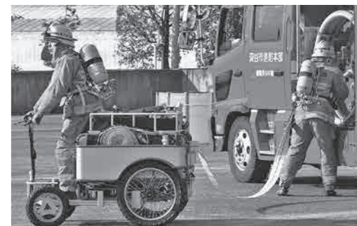
▲『電動ホースカー』を使用する様子。通常は人数がかかるホースの延長作業を少人数で行うことが可能になります。
