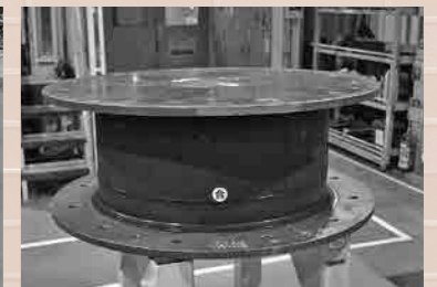
▲免震装置（積層ゴム）。新庁舎では55基設置し、この上に建物をのせます。
