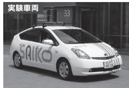
▲実証実験では、車体の内部や上部に、実験内容に応じたさまざまな装置を法律の範囲内で取り付けて自動運転を行います。実験は、時速10キロメートル程度の走行から始めます。
