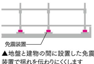
▲地盤と建物間に設置した免震装置で揺れを伝わりにくくします
