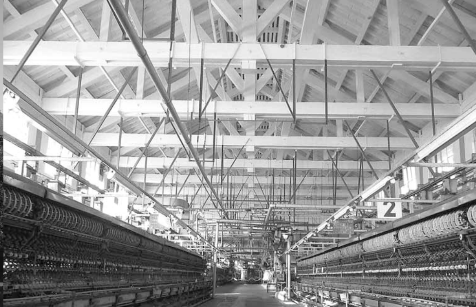
繰糸所（内部）：富岡製糸場の中核施設として、繰糸（数本の繭糸をより合わせ生糸を作る）が行われました
