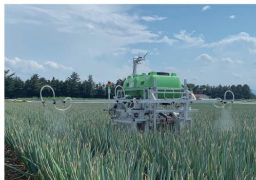
ロボットによる防除作業の実証実験
