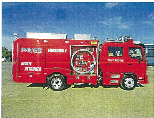
▲キャフス搭載ポンプ車
